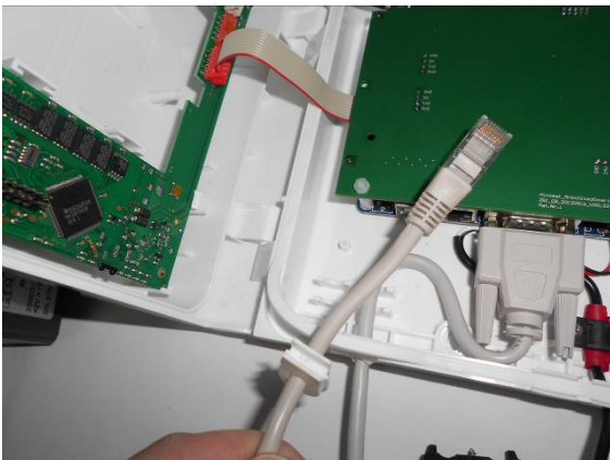
Bild 4: Anbringung der Kabeldurchführung
