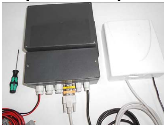
Bild 1: Anschluss des CommunicationMasters an einen Pegelwandler unter Nutzung der beiliegenden Gender Changer
